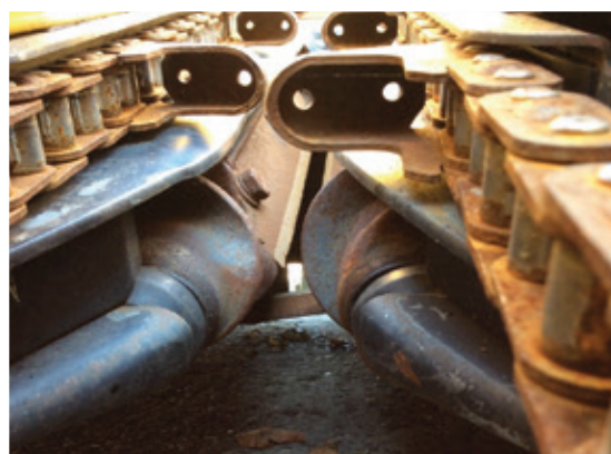
2. kép: Törőhengerek-leszedőkécek-fülesláncok Forrás: Varga Balázs Csaba, 2016
